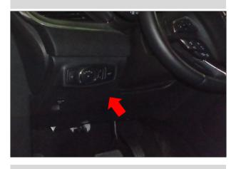
ECU 安装位置:在驾驶室内部找到大捆的线束,或者位置好的铁支架,利用扎带穿过我们 ECU 的孔,并扎紧固定住;
