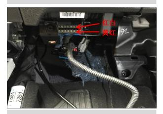
接信号线:我司红白线接 OBD 第 6 脚,黄红线接第 14 脚
