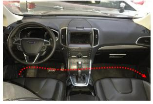
拆内饰件 把驾驶位中控台拆下,并妥善保管,后续还 原安装。(箭头)
