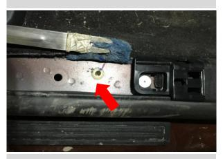
拆下卡扣后,掀起地毯拆下白色塑料件,踏 板线从此孔穿过(箭头)
