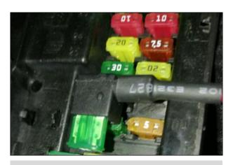
接正极线:把取电器头插如图正确插入原保 险盒取电,线接口处固定好,防止松动;注 意:如图对应位置正极插入,若反插将导致 尾门无法使用,提示:建议最后连正极取电;
