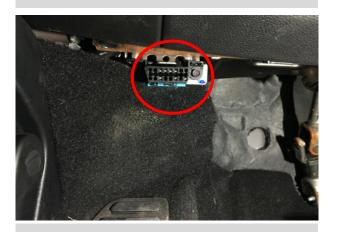
接信号线 拆下原车 OBD 插头,
