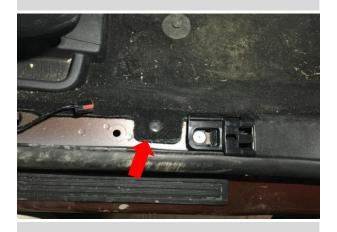
掀开迎宾踏板后,拆下此处卡扣 提示:踏板穿线孔左右两边一致。
